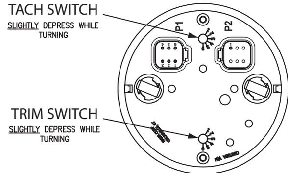
**Setting TRIM SWITCH For Some SUZUKI & MERC Engines:**
